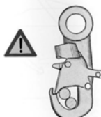
Fig. 42 - Carichi non in asse con la spina
